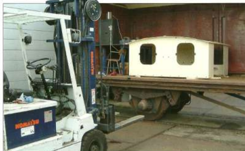
De cabine-bovenbouw van de WD 34 na terugkomst van de straler. Amsterdam, 23 augustus 2005. STIBANS-werkleden NS 162
