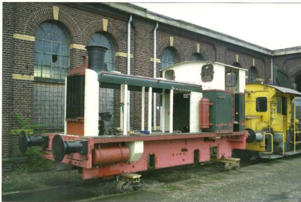
De restauratie van NS-loc 162 in Blerick is in volle gang. Op 5 april 2008 zit het casco van de hulf weer op zijn plaats. STIBANS-werkgroep NS 162
