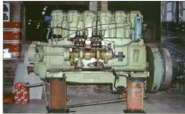
De gereviseerde Gardner 6L3-dieselmotor klaar voor inbouw in de NS 162. Blerick, 13 oktober 2007. STIBANS-werkgroep NS 162
