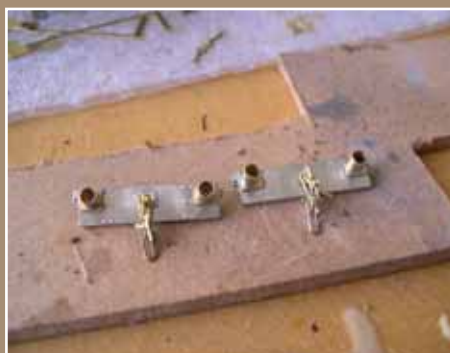
De afgemonteerde bufferbalken. De klinknagels aan de achterzijde zaten bij de montage in de weg en werden daarom weggelijfd.
