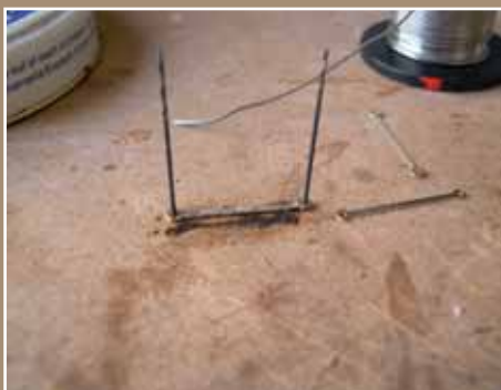
Om de laagjes van de koppelstangen netjes op elkaar te solderen, gebruikte ik twee boortjes.
