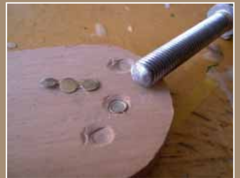
Met een speciaal stuk gereedschap worden de bufferstempels bol gemaakt.
