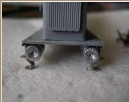
De luchtketels moeten worden uitgeboord, anders werken de verende buffers niet.
