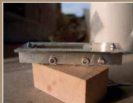
Na wat soldeerwerk zit het frame in elkaar.
