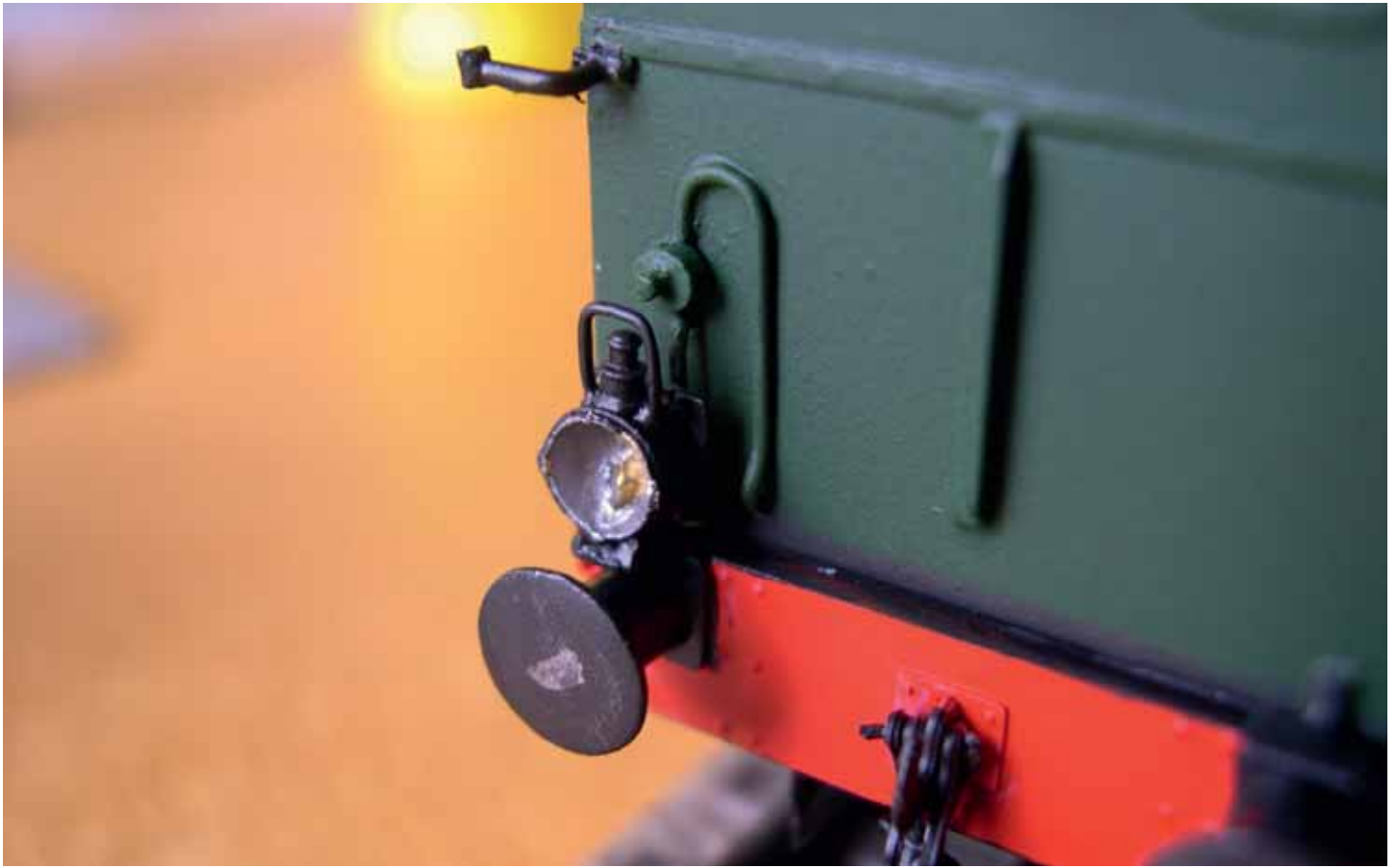
De achterwand met lantaarn en brandstofpomp.
