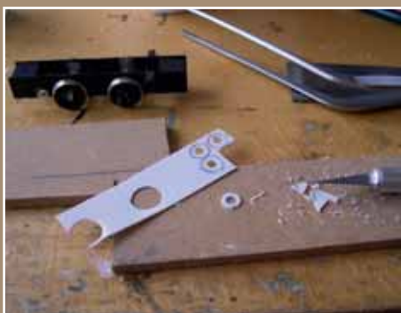
Met dunne plastic ringen wordt de zijdelingse speling van de assen beperkt.
