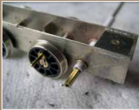
Het vierkante profiel vergemakkelijkt het kwartieren van de contragewichten.
