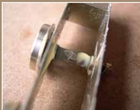
De assen worden met vloeibaar schuurmiddel in het lager rondgedraaid tot de zaak soepel loopt.
